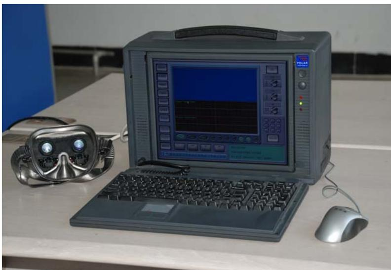
特殊视觉检查仪是采用光学系统和计算机软件生成各种视标，采用虚拟光学系统和液晶显示各种视标，采用计算机控制各项功能检查、功能转换及检测结果的存储、打印。特殊视觉检查仪是应用虚拟光学技术、计算机技术和视觉生理理论研制的一台能对人体眼科七种功能（包括远视力检查、近视力检查、色觉检测、对比敏感性测试、快速暗适应时间测定、立体视觉检测、隐斜视检查）进行检查的综合性自动检测评定视觉功能的仪器，它由光学、精密机械、电子学三个分系统组成，将七项视觉功能检查集成于一体。它主要用于飞行员、航海员、汽车、火车驾驶员的各类驾驶员体检选拔的医学检查，也是医院眼科视觉功能检查和疾病检查的必备仪器。
