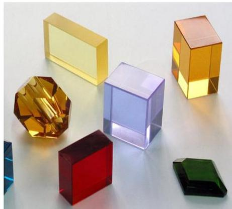
K<sub>9</sub>玻璃在K系玻璃中产量最多、应用最广，可用于加工各种光学仪器镜头及光学元件，如棱镜、码盘等，也是制作水晶工艺品的绝好材料。
