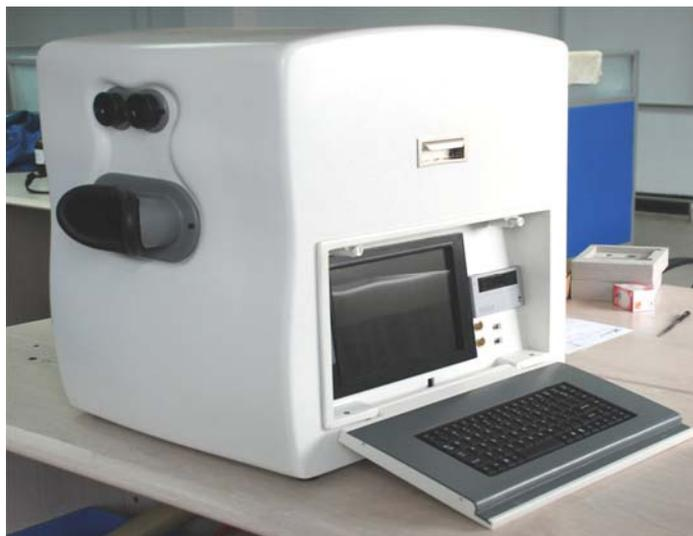
暗适应检查仪是通过光学系统产生视标，摄像显示系统监视眼动，整机采用单元机控制各项功能检查、转换，监测结果自动打印和存储的光机电一体化检查设备。它可进行主/客观暗适应检查、暗视力检查、眩光照眼后暗适应恢复时间测定等，是集光电技术于一体的检查人眼夜间视力的综合性检查仪器，主要适用于飞机、轮船、火车、汽车及各类驾驶人员和各种夜间作业人员夜间视力检查，还适用于眼科疾病、肝脏疾病、维生素 A 缺乏、锌缺乏和缺氧等各种原因所致夜盲的检查和诊断以及营养分析等方面。
