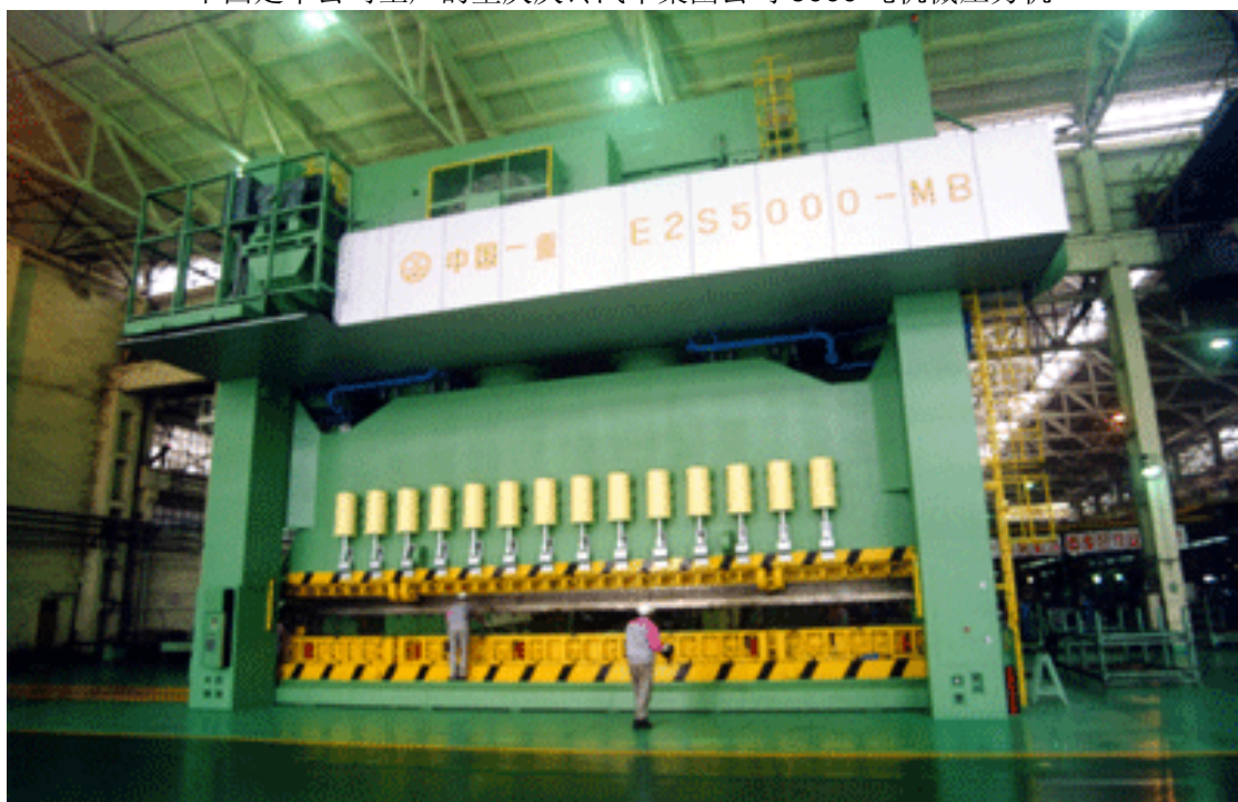
下图是本公司生产的重庆庆铃汽车集团公司 5000 吨机械压力机
