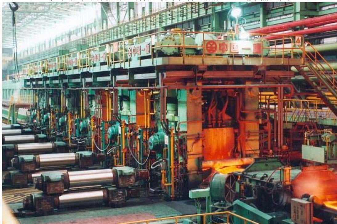
本公司生产的我国第一套自主设计轧制硅钢的 1580 毫米热连轧机
