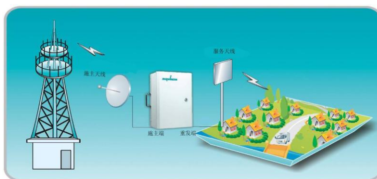
图 6-22 室内移动通信网络优化示意图
