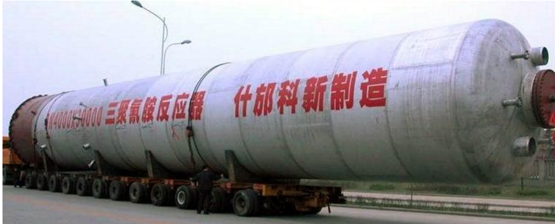
化工设备：三聚氰胺反应器（直径:4 米；长:28 米；重量:118 吨）
