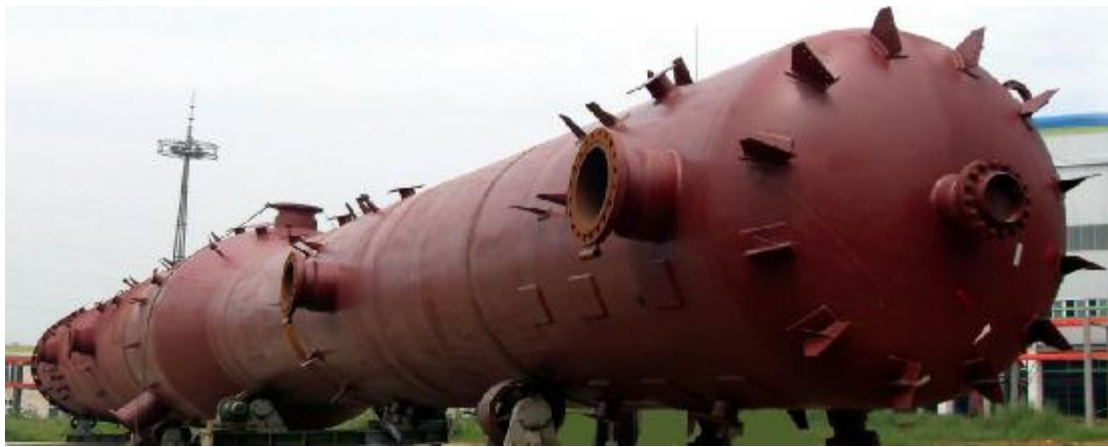
化工设备：CO 2 吸收塔（直径:2.7 米；长:43.85 米；重量:141.33 吨）
