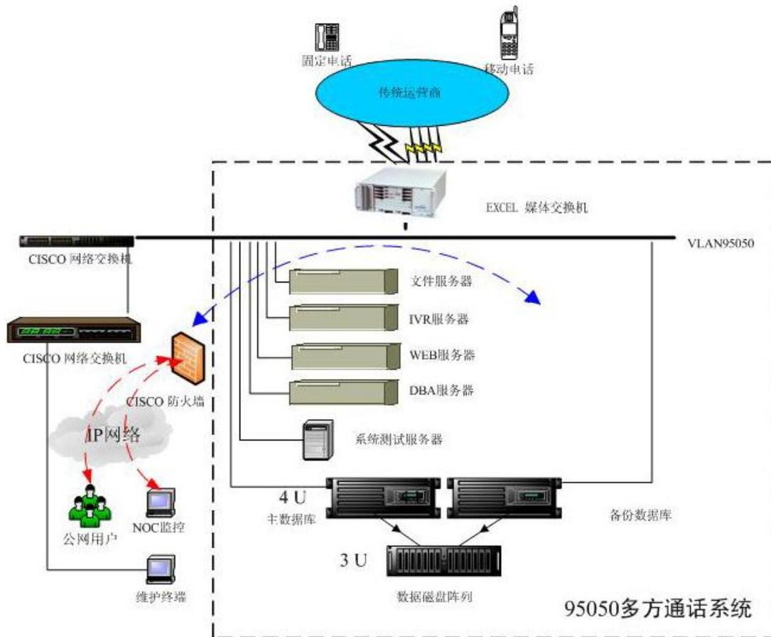
多方通话平台由 IPS + 交互式电话会议系统组成，硬件采用基于 DSP2 技术的媒体接入网关提供接入服务。采用可扩展的分布式网络架构，涵盖交换机、语音服务器、计费服务器、管理服务器等资源。
