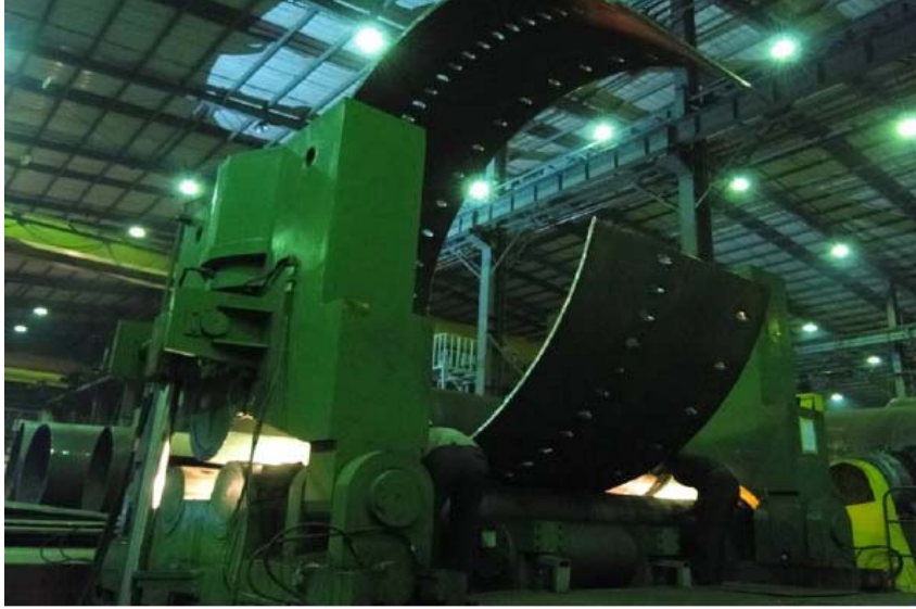
风电塔架卷板现场
