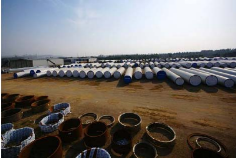
公司风电塔架贮存场所
