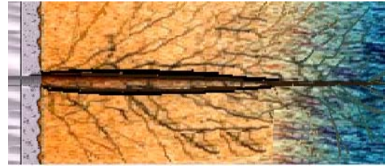
复合射孔能形成孔缝结合的裂缝网络
