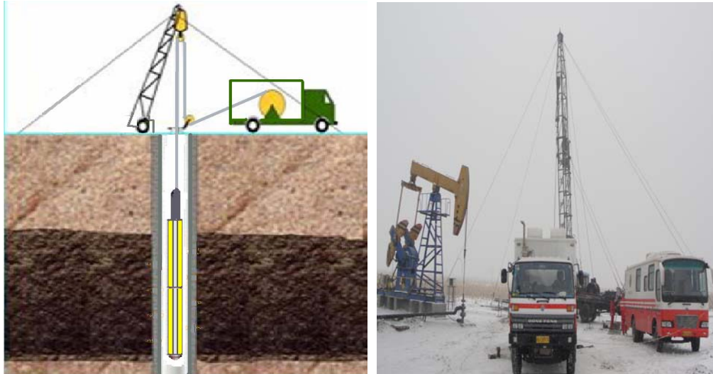
爆燃压裂作业示意图
