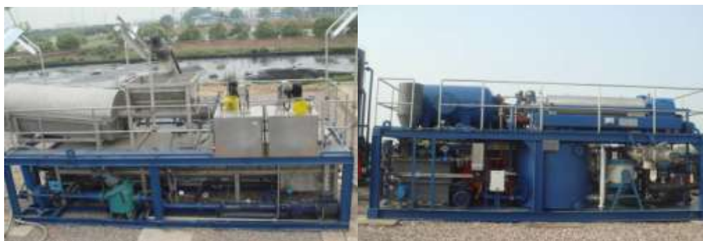
图：移动式含油污泥应急处理装置橇装化模块
