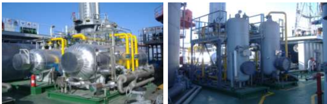
图：海洋平台高效分离器（为中石油某试采平台提供的成套装备）
