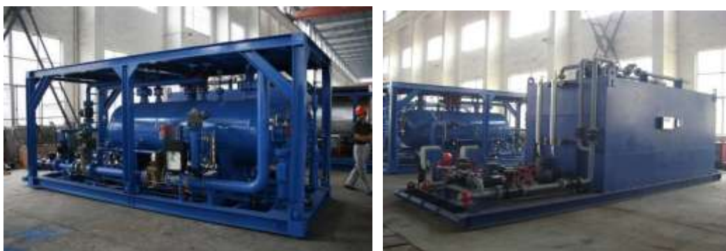
图：橇装式测试装备的核心设备（为中石油吐哈油田提供的装备）
