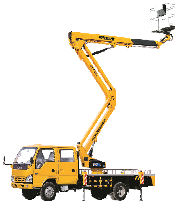
“联动折叠+伸缩”混合臂式高空作业车
