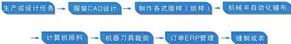
机械裁剪在上述过程中采用了计算机控制技术，生产已能够标准化，但仍需进行人工或机械半自动化铺料和人工送料；裁剪后仍需人工分拣、分类后送至缝制组缝制；此外，机械剪裁属于接触式加工，加工过程中容易须边，物料损耗大，异性图案加工困难。
