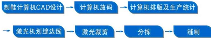
从以上工艺流程可看到，公司推出的该行业激光应用解决方案所有的过程均由计算机控制，实行的是数字化柔性生产，并由于冲剪工序被激光裁剪所取代，缩短了生产周期，使少批量高效的快速生产成为可能，适应了“快速时尚”的发展趋势。
