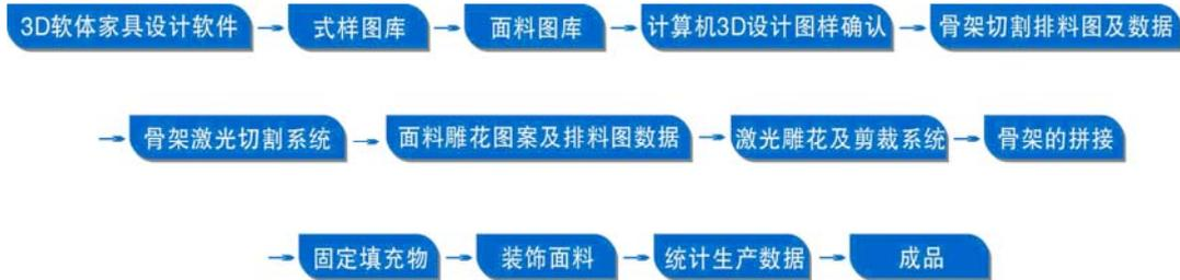
该方案采用 3D 设计造型，使产品在未生产前可模拟出产品的效果，降低了开发成本，缩短了开发时间；采用激光切割骨架技术，使骨架的造型可以采取异型结构，大大的丰富了家具的款式；采用激光柔性雕花技术，可批量生产出不同个性、不同种类的装饰面料，使软体家具更具个性化、时尚化。此外，公司还在工艺家具、玻璃家具和钢制家具制造中，推出各具特色的解决方案。
