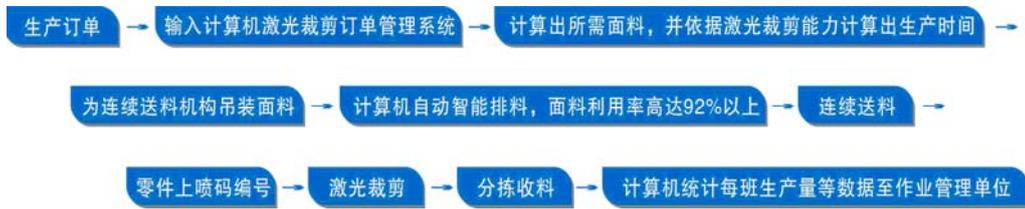
该解决方案是依据生产订单开始，生产过程表现出极大的灵活性，裁剪过程可随时监控并进行数据分析、定量管理，使产品的品质得以保证；同时，由于采用连续送料裁剪模式，人工大为减少，生产效率成倍提高。该解决方案的主要产品机型为 CJG-2501000 多头激光裁床。
