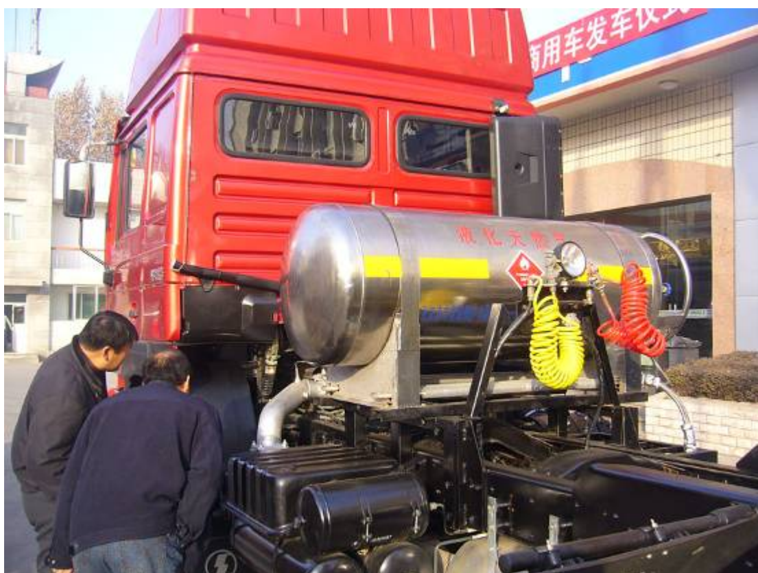
上图为车用供气系统在重型卡车上的应用。
