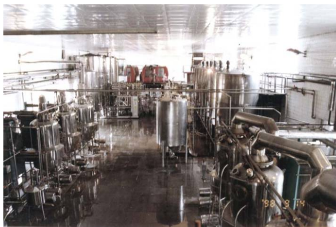
板式蒸发装置应用于国投中鲁果汁有限公司营口分公司四效浓缩装置
