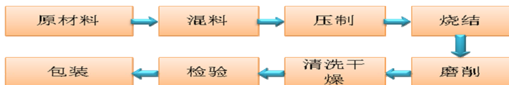
(3) 粘结磁产品工艺流程图
