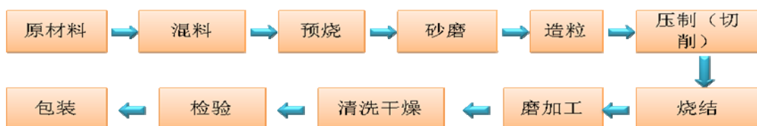
(2) 镍锌软磁铁氧体工艺流程图
