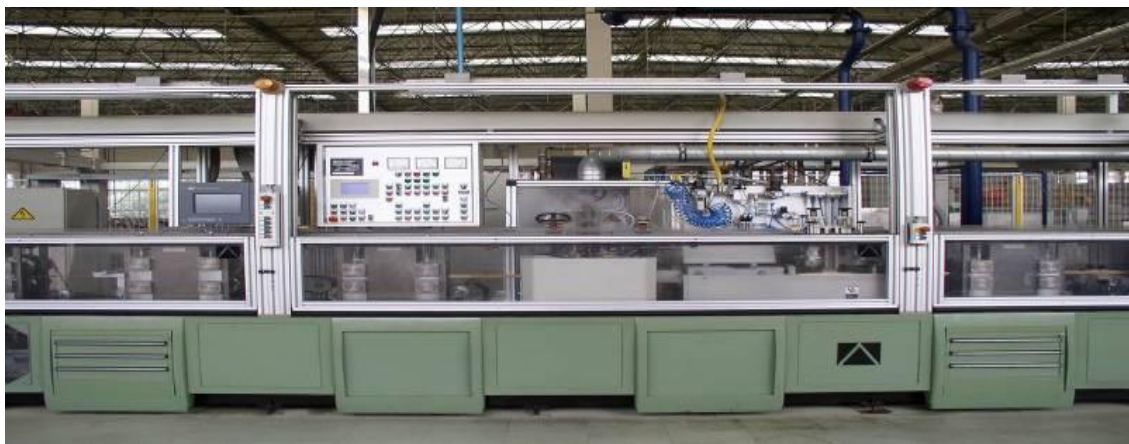
图 3、从德国引进的高频焊接高速制管机组
