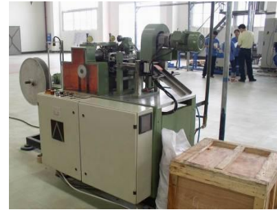
图 6、从德国引进的离路散热带制带机
