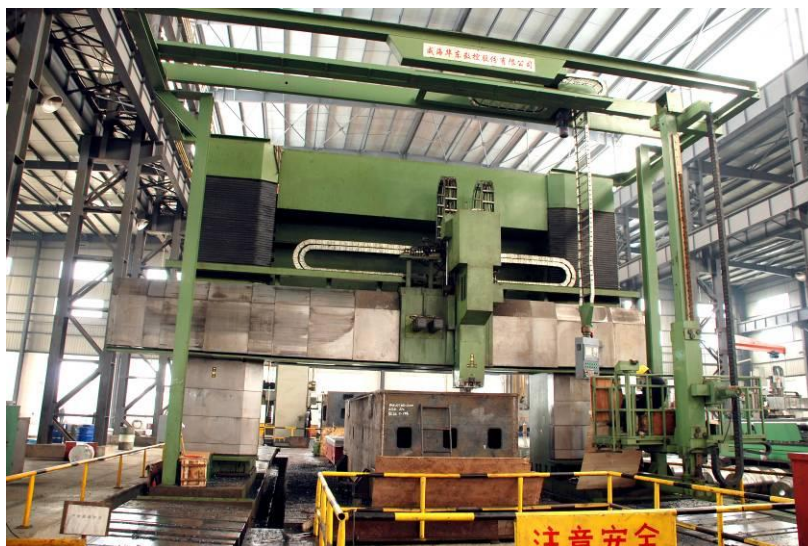
动梁龙门移动式数控镗铣床（工作台 16×5m）
