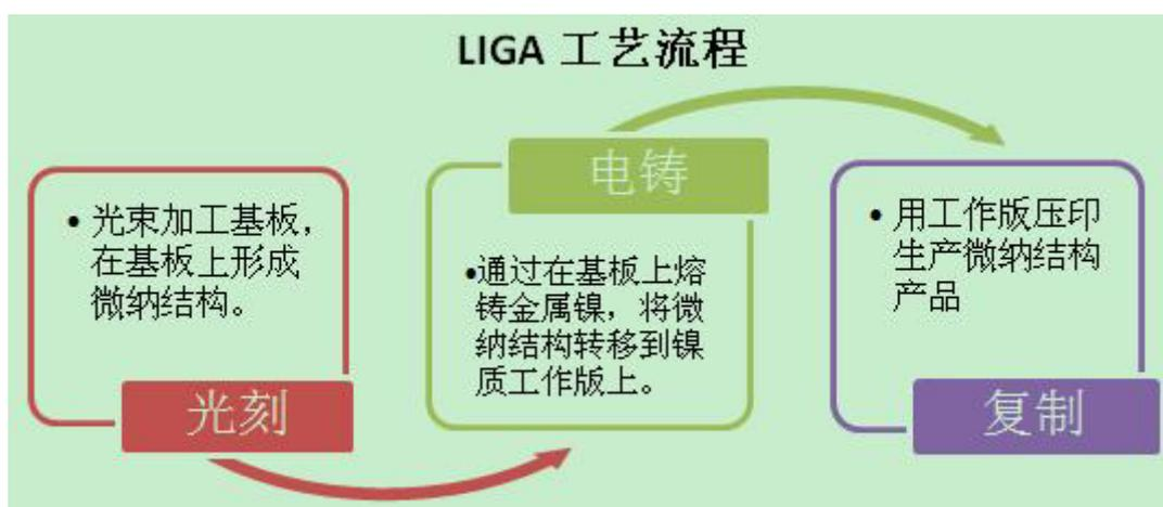
LIGA 技术在过去 20 年里取得了突飞猛进的进展，不断突破 180nm、60nm、35nm 等节点，已经进入纳米尺度，推动了微纳光学技术及相关器件的发展，并且 LIGA 工艺也在不断改进，生产效率持续提高。如微纳结构产品的复制环节，现在已普遍采用压印工艺取代了原有的注塑工艺，压印工艺能够实现连续生产，
