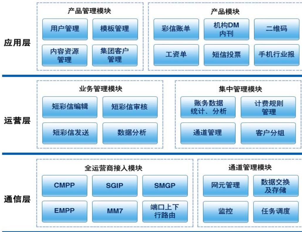
该平台由通信层、运营层和应用层构成。其中通信层是平台的基础，提供基础通信功能和数据交换处理及监控功能；运营层提供面向集团客户的集中式运营服务和业务管理服务；应用层承载各个标准化的产品逻辑，能够快速耦合客户系统。以下是通信层、运营层和应用层的具体功能：
