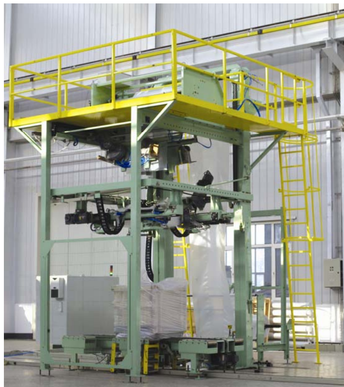
LT60 型拉伸套膜包装设备
