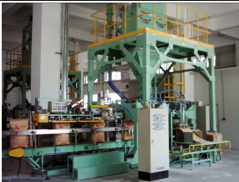
ZBF800 型粉料预制开口袋称重包装设备
