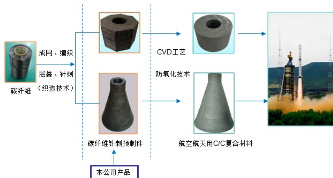
航空航天用 C/C 复合材料工艺示意图
