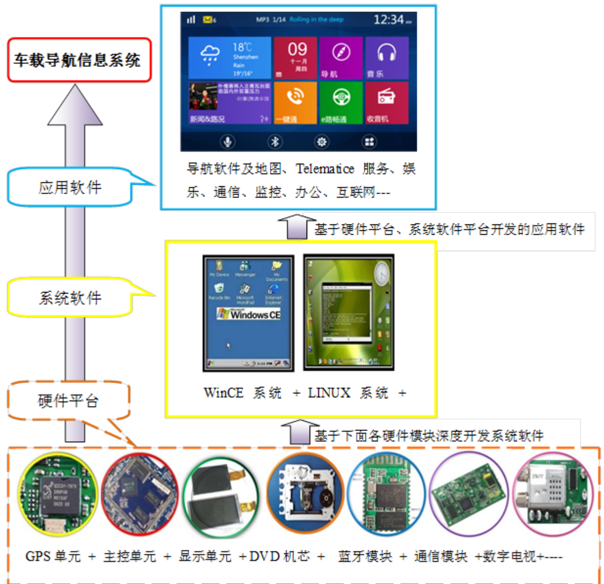
车载导航信息系统结构
