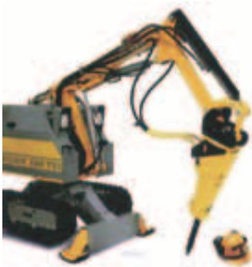
遙控拆卸機械人，一般安裝了液壓破碎錘及液壓破碎機，以運用各種方式(如壓碎或破碎)進行混凝土拆卸工作
