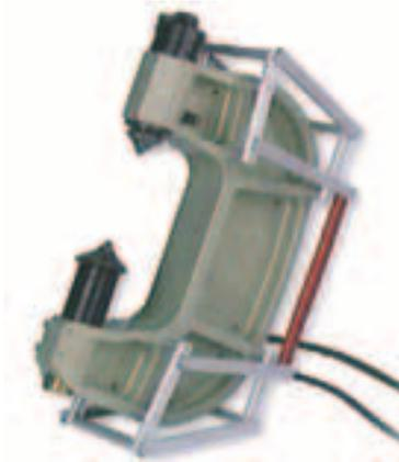
混凝土壓碎機，用於以壓碎方式進行混凝土拆卸工作
