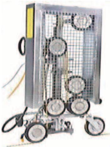
鏈式切割機，用於混凝土拆卸工程中的鏈切割工作
