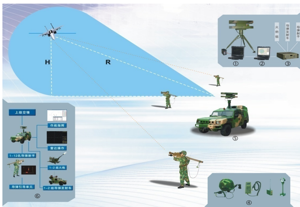
图：TH-S311 系统组成及系统连接示意图
