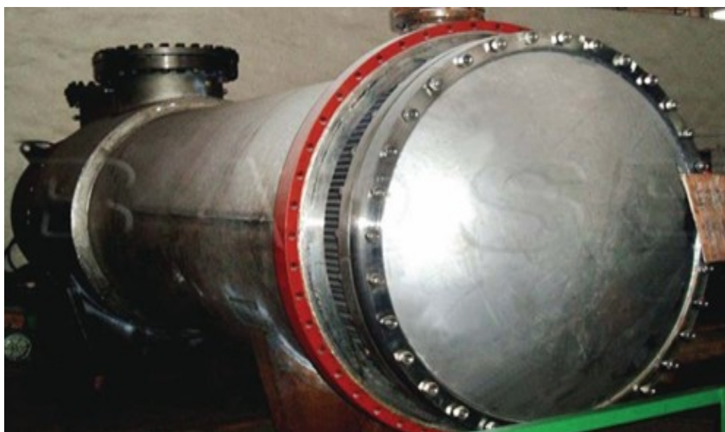
脱氢塔冷凝器
