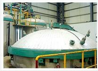
Φ5.4m真空压力浸漆 (VPI)
