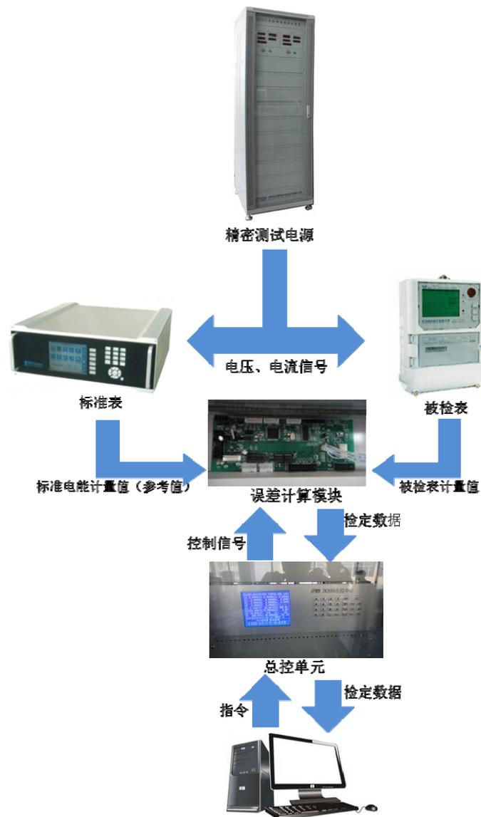
精密测试电源输出幅值、相位和频率可调的电压、电流信号分别输入标准表和被检表，标准表通过乘法和积分运算生成标准电能数据，被检表同时对相同电压电流信号在相同时间区间的电能进行计量。标准表和被检表两组电能数据同步输入误差计算模块，通过比较运算得出被检表的计量误差。误差数据通过总控单元传输到外部计算机。
