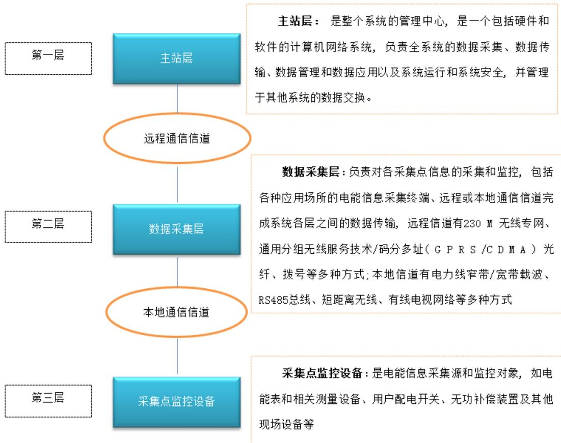
公司可以提供主站管理软件系统、采集终端和三相电能表，针对电力用户的用电信息进行采集处理和实时监控，实现用电信息的自动采集、计量异常监测、电能质量监测、用电分析和管理相关信息发布等功能。
