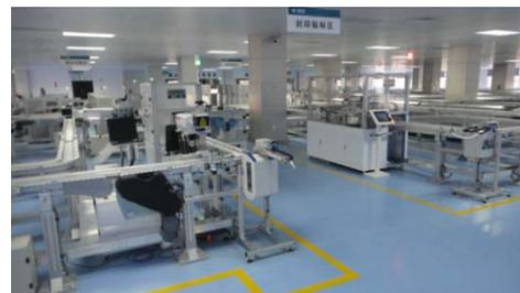
计量中心自动化流水线检定作业流程为：根据营销系统下达的检测任务，通过计量管理平台协调，先由仓储系统将待检表箱出库，由表箱输送线将待检表箱依次送至相应的上料模块，由上料机械手取表放入检测输送线，自动完成外观和标志检查、耐压试验、功能测试、准确度检测和多功能试验等操作。检测完毕后，系统根据检测结论，通过输送线自动完成分拣、输送，并将各作业环节的不合格品输送至异常下料装箱口，完成不合格品装箱，同时对合格品进行封印、贴合格证、按产品规格自动分类装箱等作业。完成检定的表计装箱后由仓储系统完成合格表箱、不合格表箱的入库工作，同时通知计量管理平台将检测信息、封印信息、装箱信息上传至营销系统。
