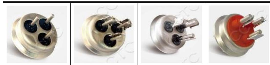
接线端子作为压缩机的核心部件之一，是确保压缩机绝缘和密封性能的重要电气元件，实现承受高压下的气密性和高介电绝缘强度，安全性要求较高。接线端子产品的生产技术关键在于玻璃粉配制以及玻璃与金属封装技术，玻璃材料具有卓越的机械、电学和密封性能和稳定性，可靠的玻璃与金属封装技术可确保产品整体性能稳定，确保压缩机在恶劣的使用环境下安全运行。
