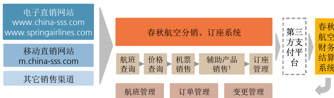
春秋航空分销、订座、结算系统流程示意图
