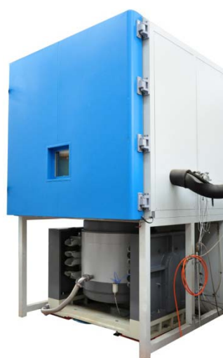
四综合试验系统
