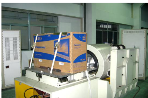
电视机包装运输振动试验
