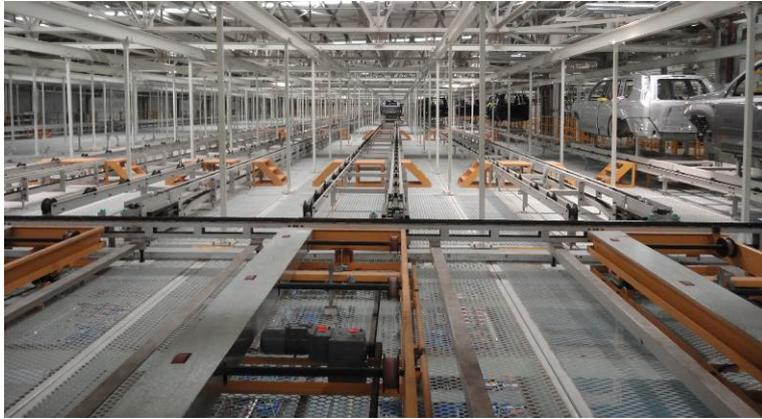
滑橇式输送成套装备是利用动力滚床驱动滑橇带动工件完成运行、旋转、平移的成套设备。该系统具有运行平稳，性能稳定的特点，特别是采用带式驱动方式后，系统实现了输送速度快、传动效率高、噪音低、污染小等特点，主要应用于汽车行业。
