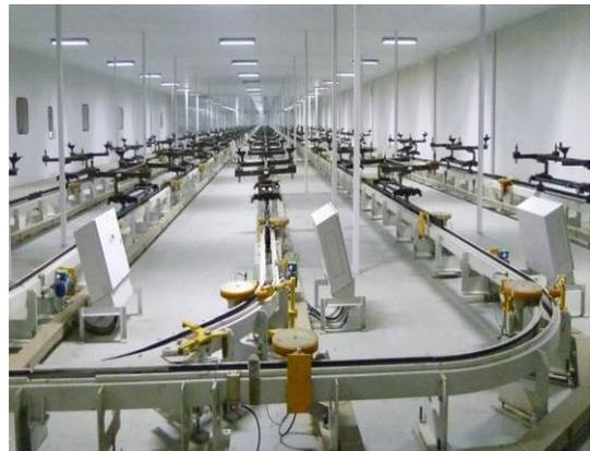
摩擦式输送系统是一种采用多点小功率电机减速机驱动特殊材质的驱动轮，通过摩擦力带动工件完成运行、旋转、平移等动作，广泛地应用在电子商务、汽
