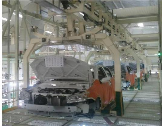
链式输送成套装备是一种主要以链条传递动力带动工件完成运行、旋转、平移的成套设备。适用于高生产率、柔性自动化生产系统。该系统既能完成物件连续输送又能解决分类储存问题，使整个工厂生产和仓储的所有工序连接起来，成为一个完整的运行系统。广泛地应用在电子商务、汽车、医药、机械、家电等行业。
