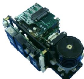
长波制冷红外热像仪
