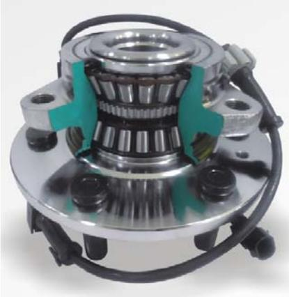
第三代轮毂轴承单元集成了轮毂轴承、安装凸缘、万向节凸缘芯轴和传感器，结构更复杂且集成度高。 |
