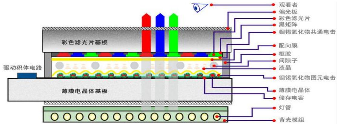
基板玻璃在 TFT-LCD 面板原材料成本中的占比约为 22%，对面板产品性能的影响巨大。TFT-LCD 面板成品的分辨率、透光度、厚度、重量、可视角度等指标均与所采用的基板玻璃质量密切相关。作为重要的基底材料，基板玻璃对于 TFT-LCD 面板产业具有重大意义。
