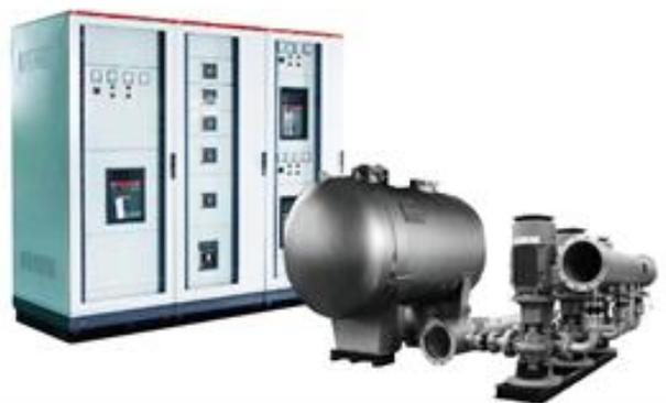
**③箱式无负压供水设备：**产品适用于管网条件不稳定区域的高层供水。产品利用水箱作为整个系统的备用水源，具有一定的调蓄能力，充分满足高峰期间不断水停水的要求。当自来水管网压力不足或无水时，自动投入使用，补充供水，以保证供水的稳定性和连续性；当自来水管网压力恢复后自动转换为正常叠压供水方式，水箱自动补水，
