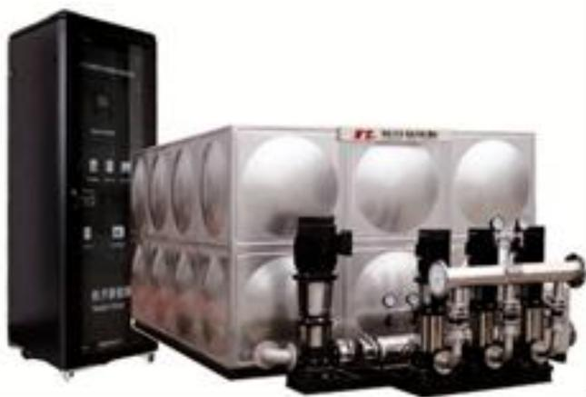
**④ 罐式无负压供水设备：**该产品主要的特点为无需建水池、设水箱，采用微机变频技术，通过真空补偿系统的全封闭结构，直接和市政管网串接加压供水，既不对市政管网产生负压影响，又可充分利用市政管网的原有压力，能耗低，占地面积小，大大节省了投资成本。且设备的全密闭结构，实现水质改善和保障。
