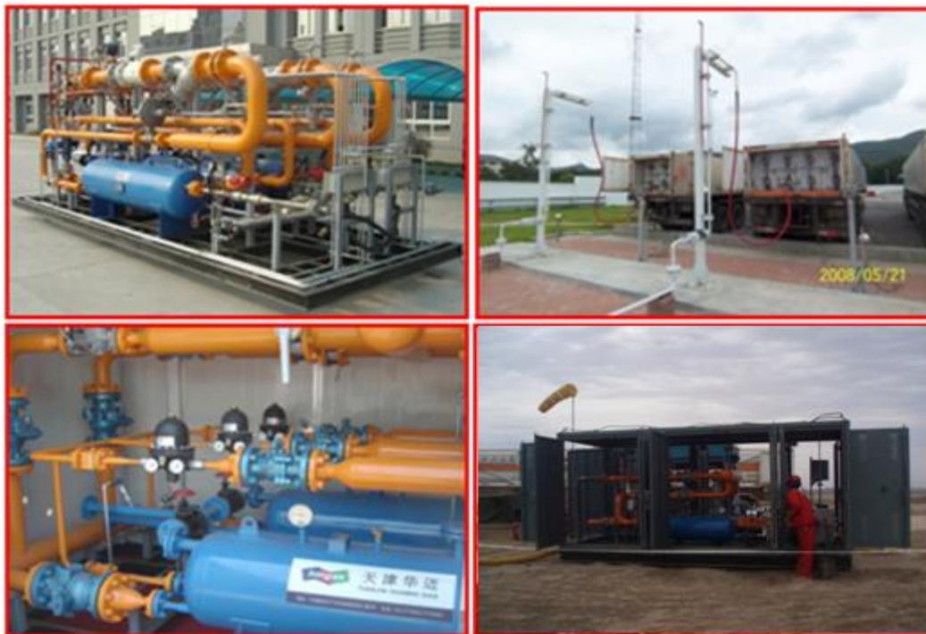
CNG 调压设备主要功能为将输入端压力值较高（通常为 20MPa 左右）的压缩天然气通过换热、减压输出为可直接使用的常压天然气（0.2—0.4MPa）。主要满足管网覆盖范围外或者使用管网天然气不经济的工业用户对点供天然气设备的需求，此外还有小部分用于城市调峰备用气源。
