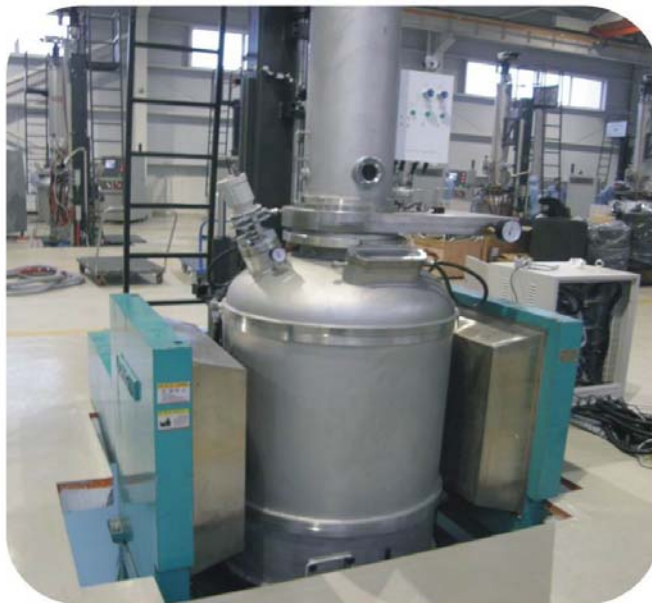
施加横向磁场的 CZ 生长炉
