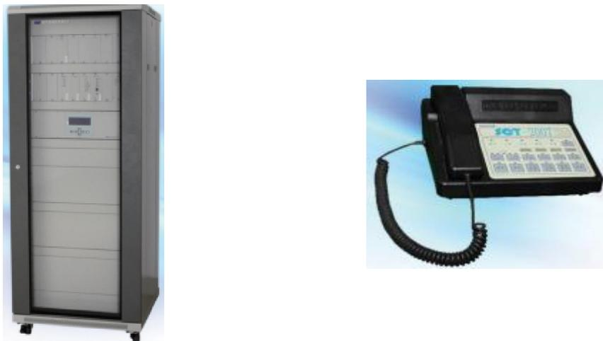
TCZS-450I 型车站电台是分布于铁路沿线各个车站的集有线/无线通信、数字语音/数据业务、数字传输和数字交换等功能于一体的核心设备，放置在车站通信机械室，供车站值班员使用。其由机柜、主控、交换、管理、调度接口单元、本站电源、控制盒单元、信道机、天馈系统等基本部件组成，可根据需要选配数传、区域联锁、区间接口，区间耦合和远供电源等部件。
