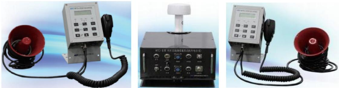
WTTJ-II 型通用式机车电台是用于机车司机通话和收发数据业务的通信终
