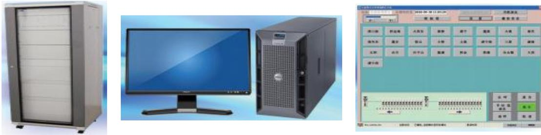
DZ-I 型调度总机是列车无线调度通信系统的重要组成设备，设置在调度所，供调度值班员指挥行车使用。其由调度机柜设备、调度操作台、送话器、音箱及连接线缆组成，通过有线数字通道（64K/2M）与车站电台连接，具有与车站值班员和机车司机通话的功能，并为监测总机的系统管理和监测提供数据通道。
