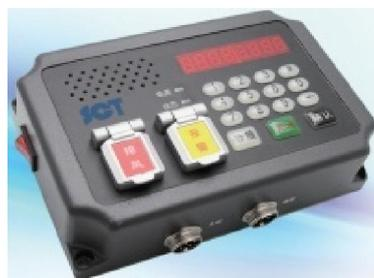
WTHZ-II 型 800MHz 机车电台（简称：LBJ）是列车防护报警和客车列尾系统的重要组成部分，安装在列车上，与客列尾（KLW）、其他防护报警设备等组成 800MHz 的列车无线防护报警系统和列尾查询/排风制动系统。其由主机、控制盒、天线和连接电缆组成。
