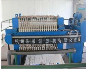
污水处理设备：全自动板框压滤机
