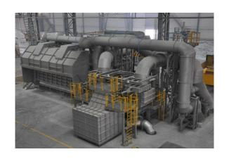
公司回收各生产环节废铝及客户生产环节边角料,同时公司与国内知名废铝回收公司紧密合作,回收可用于再生产的铝制品。回收废铝采用双室炉熔,双室炉的密闭双室确保处理过程中杂质燃烧得到完全控制,不会污染大气和车间;同时双室炉能减少热量的散失,降低能耗;还可降低氧化产生的烧损约 6%。回收铝相对于电解铝可节能95%。
