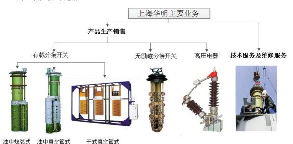
分接开关是变压器的重要部件之一,它的原理是通过改变变压器线圈匝数之比,达到改变变压器的输出电压,因此又被称为调压开关。有载分接开关可以在不停电的状态下改变变压器输出电压;无励磁分接开关则只能在停电状态下调压。根据国际电工委员会(IEC)标准和中国国家标准强制性规定,35KV以上的电力变压器必须安装调压分接开关。由于分接开关自带的控制器具有各种通讯规约,因此能方便地和综合自动化系统进行后台通讯,实现自动调压。远距离控制通讯是分接开关产品的核心技术之一。该技术可实现对变压器的远距离控制,还可对电网电压、负荷、档位、设备状况等进行遥测,并收集电网的运行数据。这为今后电网大数据、调度自动化等新的电网发展方向提供了技术保证。因此,分接开关兼具电气一次设备和二次设备的功能和特点。
