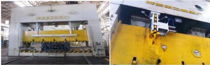
(整改前：压力机无安全防护措施，存在隐患)(整改后：加装防坠落安全装置，降低安全风险)
