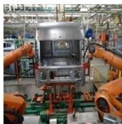
(车身焊接质量在线检测机器人)
