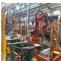
(焊钳焊接机器人)
