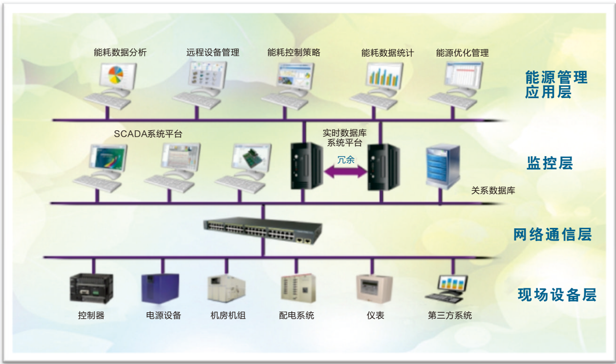
■ 能源管理职能监控平台
