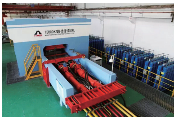
／武汉船机建造的亚洲第一 75000KN 减隔震产品多功能试验机
