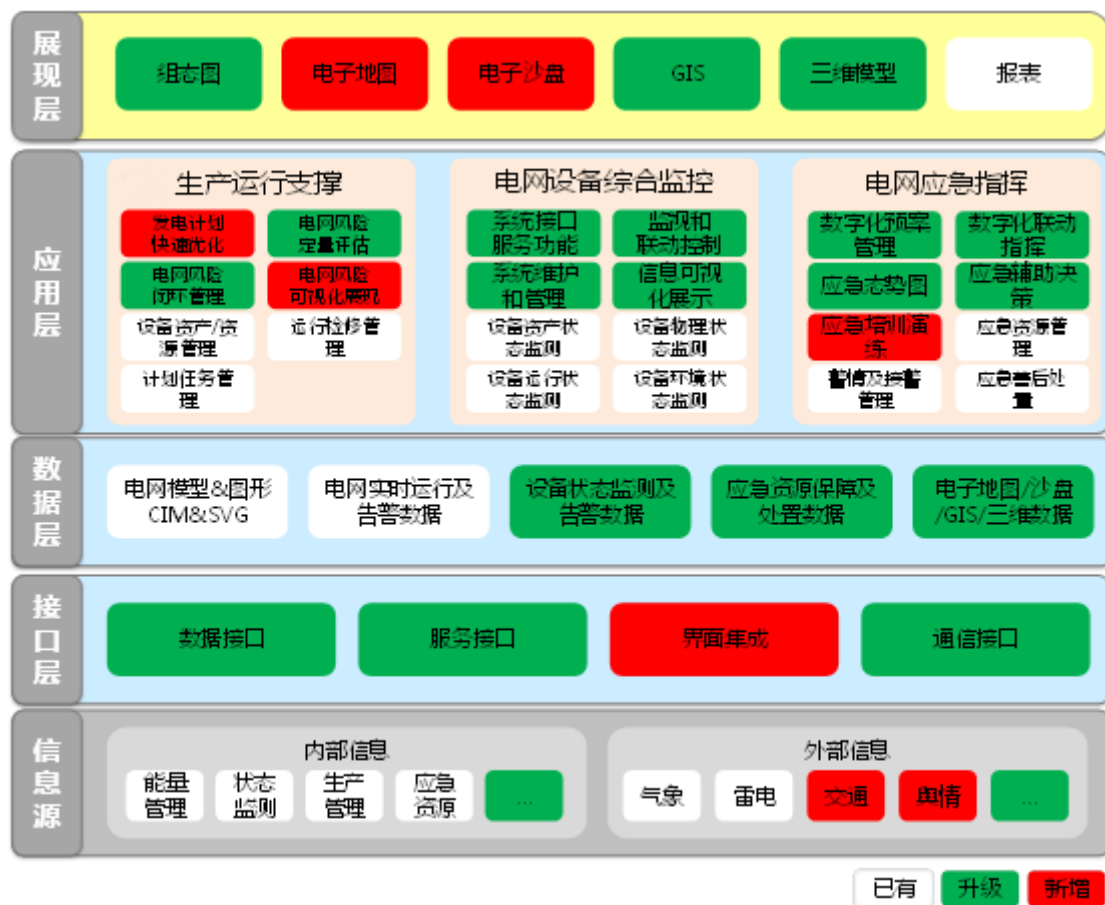
智能电网安全生产监控解决方案总体架构
