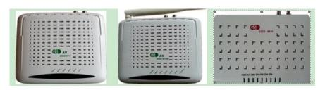
此设备可使用同轴电缆将计算机、路由器、交换机、IP 电话、机顶盒等网络设备接入互联网。
