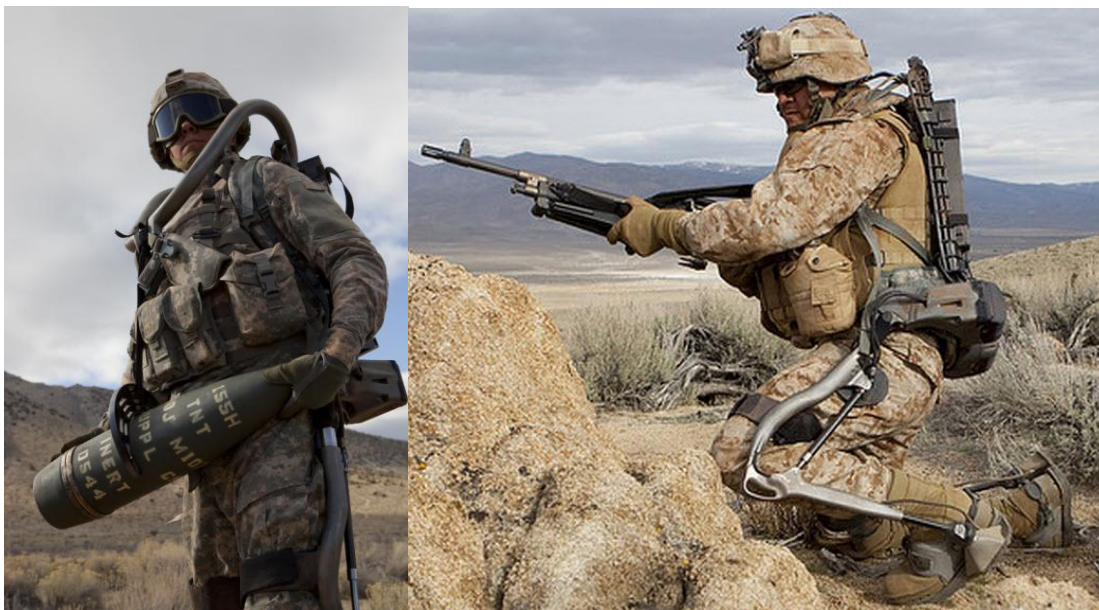
图 4：美军外骨骼机器人 HULC
