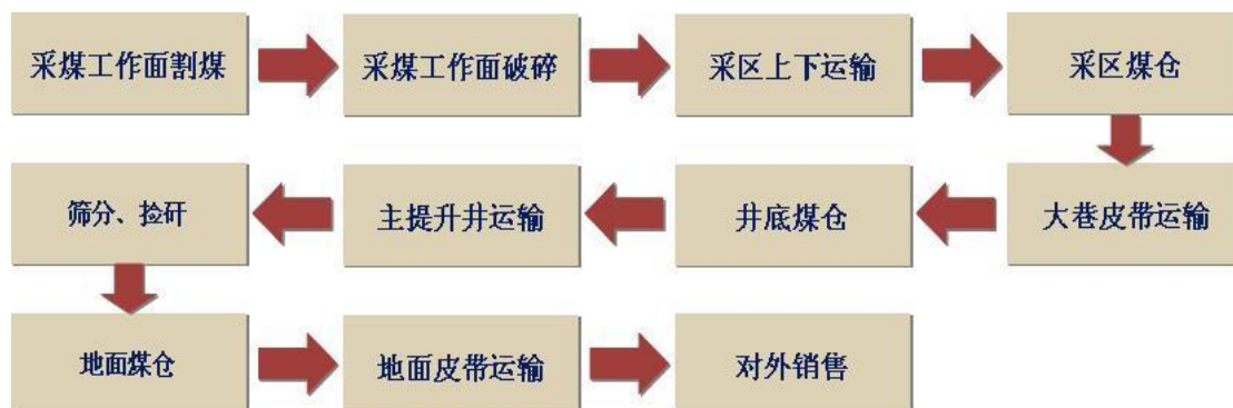
图 发行人焦煤原煤生产工艺流程图
