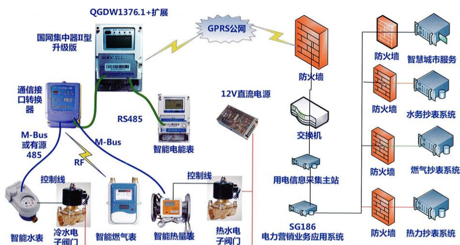
电、水、气、热一体化抄表网络拓扑图
