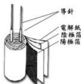
铝电解电容器基本结构图
