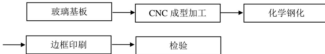
(2) 薄型 On-Cell 触控显示屏工艺流程
