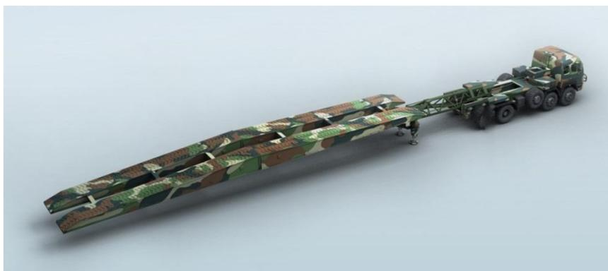
图7 某型重型机械化桥示意图
