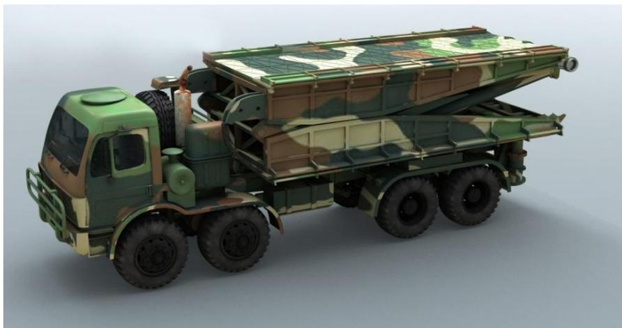
图8 某型机械模块化桥示意图
